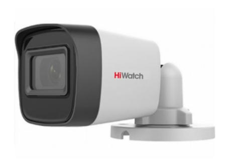
5Мп уличная цилиндрическая HD-TVI камера с EXIR-подсветкой до  $20 \text{м}\ 1/2.5$ " CMOS матрица; объектив 2.4мм; угол обзора  $110^\circ$ ; 2592 x 1944 @ 20 k/c, 2560 x 1440/1920 x 1080 @ 25 k/c; механический ИК-фильтр;  $0.01\ \text{Л}\ \text{k}\ \text{@}\text{F}1.2$ ; OSD, DWDR, BLC, DNR; EXIR Smart ИК; видеовыход:  $1\ \text{x}\ \text{HD-TVI/AHD/CVI/CVBS}$ ; IP67;  $-40^\circ\text{C}$  до  $+60^\circ\text{C}$ ;  $12B\ \text{DC}\pm25\%$ , 5Bт макс.
