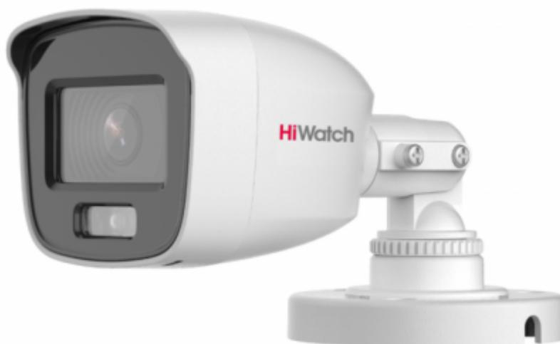
2Мп уличная цилиндрическая HD-TVI камера с LED-подсветкой до 20м и технологией ColorVu 1/3" CMOS матрица; объектив 2.8мм; угол обзора 102°; механический ИК-фильтр; 0.001 Лк@F1.0; DWDR, HLC, 3D DNR; LED; видеовыход: 1 x HD-TVI/AHD/CVI/CVBS; IP66; -40°C до +60°C; 12В DC±25%, 2,4Вт макс.
