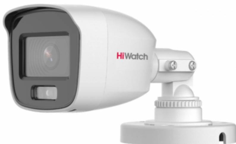
2Мп уличная цилиндрическая HD-TVI камера с LED-подсветкой до 20м и технологией ColorVu 1/3" CMOS матрица; объектив 3.6мм; угол обзора 80°; механический ИК-фильтр; 0.001 Лк@F1.0; DWDR, HLC, 3D DNR; LED; видеовыход: 1 x HD-TVI/AHD/CVI/CVBS; IP66; -40°C до +60°C; 12В DC±25%, 2,4Вт макс.
