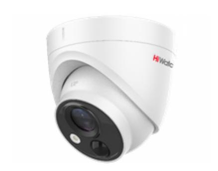
2Мп уличная купольная HD-TVI камера с EXIR-подсветкой до 20м и PIR 1/2,7" CMOS матрица; объектив 2.8мм; угол обзора  $103^\circ$ ; механический ИК-фильтр; 0.01лк @F1.2; OSD-меню, DWDR, 2D DNR, HLC, BLC, Smart ИК, PIR-датчик ( $110^\circ$  х 11м)\*, световая сигнализация; выход "сухой контакт"; видеовыход: 1 х HD-TVI; IP67, -40°C до +60°C; 12B DC±25%, 2,9Bт макс.
