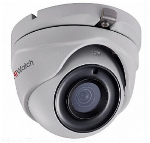
5Мп уличная HD-TVI камера с EXIR-подсветкой до 20м 1/2.5" CMOS матрица; объектив 6мм; угол обзора 46°; 2592x1944@20к/с, 2560x1440@25к/с; механический ИК-фильтр; 0.01 Лк@F1.2; DWDR, BLC, DNR; EXIR Smart ИК; OSD-меню; видеовыход: 1 x HD-TVI; IP67; -40°С до +60°С; 12В DC±15%, 5Вт макс.
