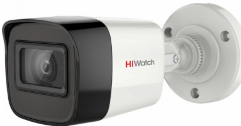
5Мп уличная цилиндрическая HD-TVI камера с EXIR-подсветкой до 40м 1/2.5" CMOS матрица; объектив 2.8мм; угол обзора 85°; 2592x1944@20к/с, 2560x1440/1920x1080@25к/с; механический ИК-фильтр; 0.01 Лк@F1.2; OSD, DWDR, BLC, DNR; EXIR Smart ИК; видеовыход: 1 x HD-TVI; IP67; -40°C до +60°C; 12В DC±15%, 5Вт макс.
