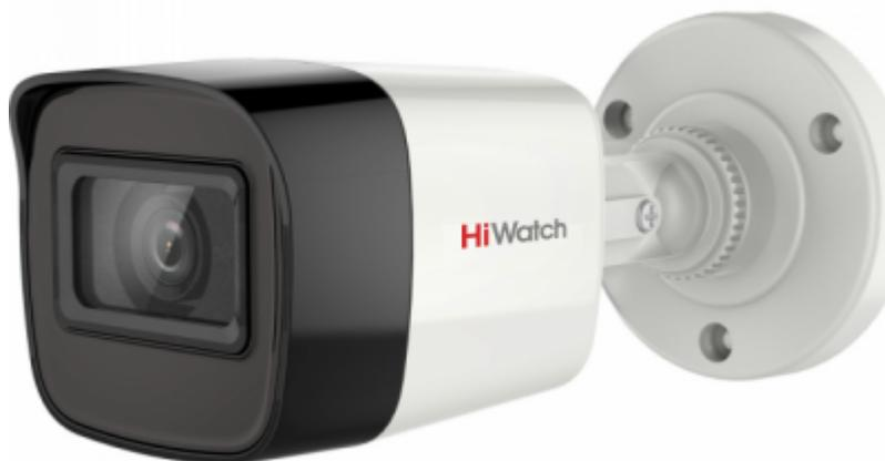
5Мп уличная цилиндрическая HD-TVI камера с EXIR-подсветкой до 40м 1/2.5" CMOS матрица; объектив 6мм; угол обзора 57°; 2592x1944@20к/с, 2560x1440/1920x1080@25к/с; механический ИК-фильтр; 0.01 Лк@F1.2; OSD, DWDR, BLC, DNR; EXIR Smart ИК; видеовыход: 1 x HD-TVI; IP67; -40°C до +60°C; 12В DC±15%, 5Вт макс.
