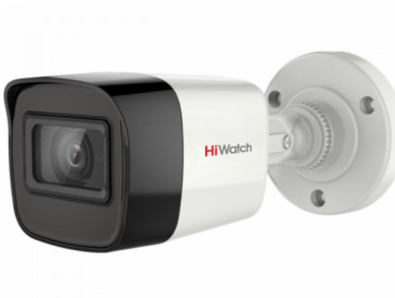
5Мп уличная цилиндрическая HD-TVI камера с EXIR-подсветкой до 40м 1/2.5" CMOS матрица; объектив 3.6мм; угол обзора 80°; 2592x1944@20к/с, 2560x1440/1920x1080@25к/с; механический ИК-фильтр; 0.01 Лк@F1.2; OSD, DWDR, BLC, DNR; видеовыход: 1 x HD-TVI; IP67; -40°C до +60°C; 12В DC±15%, 5Вт макс.
