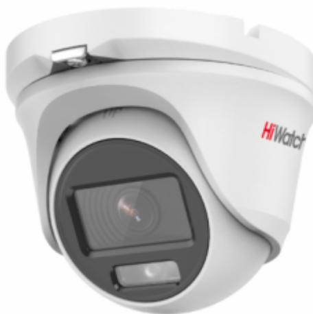
2Мп уличная купольная HD-TVI камера с LED-подсветкой до 20м и технологией ColorVu 1/3" CMOS матрица; объектив 2.8мм; угол обзора 102°; механический ИК-фильтр; 0.001 Лк@F1.0; DWDR, HLC, 3D DNR; LED; видеовыход: 1 x HD-TVI/AHD/CVI/CVBS; IP66; -40°C до +60°C; 12В DC±25%, 2,4Вт макс.
