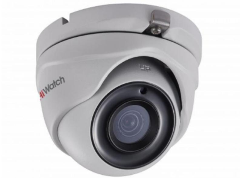
2Мп уличная купольная HD-TVI камера с EXIR-подсветкой до 20м и технологией PoC 1/2.7" CMOS матрица; объектив 2.8мм; угол обзора 103°; механический ИК-фильтр; 0.01 Лк@F1.2; OSD, DWDR, BLC, DNR; Smart ИК EXIR; видеовыход: 1 x HD-TVI; IP67; -40°C до +60°C; 12В DC±15% / PoC af, 4Вт макс.
