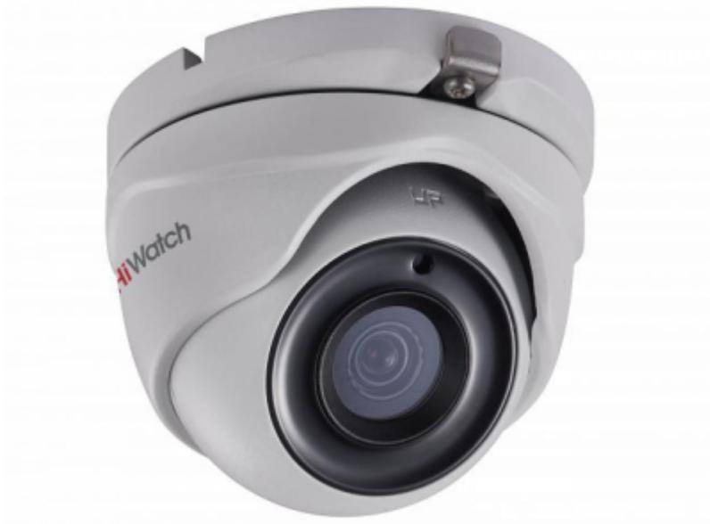
2Мп уличная купольная HD-TVI камера с EXIR-подсветкой до 20м и технологией PoC 1/2.7" CMOS матрица; объектив 6мм; угол обзора 54.4°; механический ИК-фильтр; 0.01 Лк@F1.2; OSD, DWDR, BLC, DNR; Smart ИК EXIR; видеовыход: 1 x HD-TVI; IP67; -40°С до +60°С; 12В DC±15% / PoC af, 4Вт макс.
